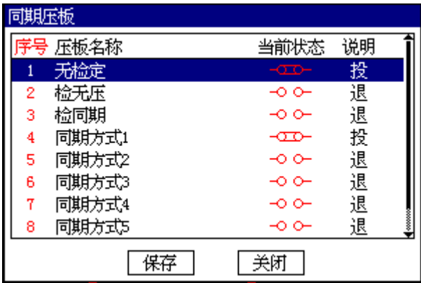
图 12-3-6 同期方式压板的投退窗口示例
