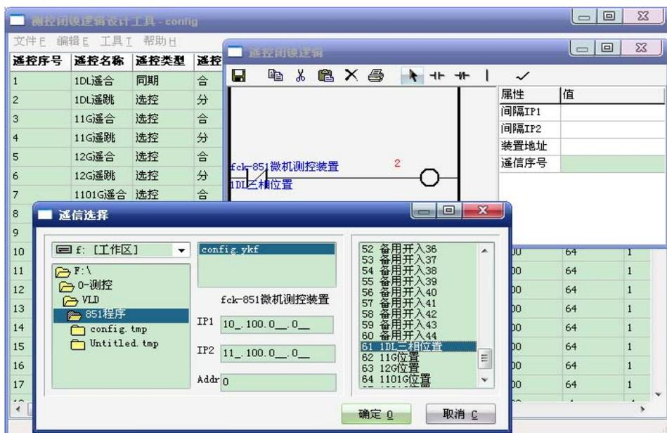
图 1 闭锁逻辑一键配置工作界面
