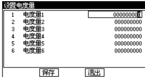
图 12-3-5-7 设置脉冲电度初值的窗口示例
