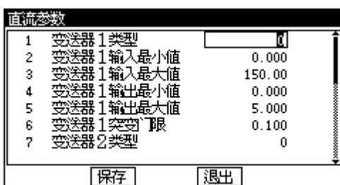
图 12-3-5-4 直流参数整定的窗口示例
