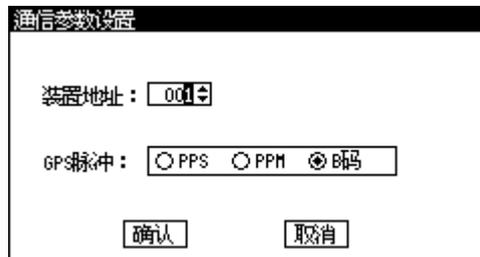
图 12-3-10-3-1 通讯参数的窗口示例
