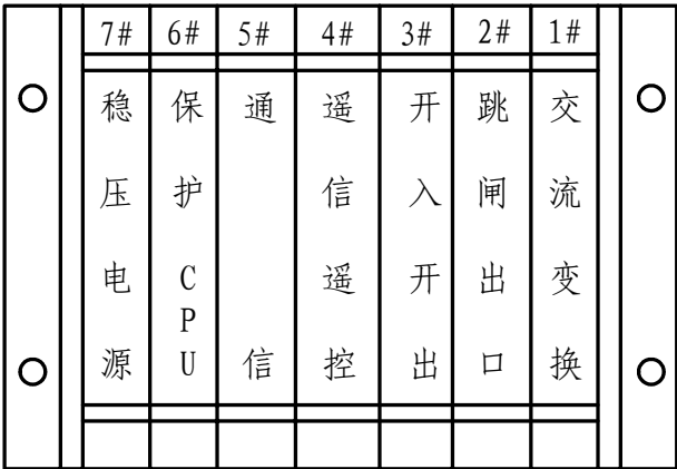
图 4-2-1 带测控功能的 WBH-813 装置背视示意图
