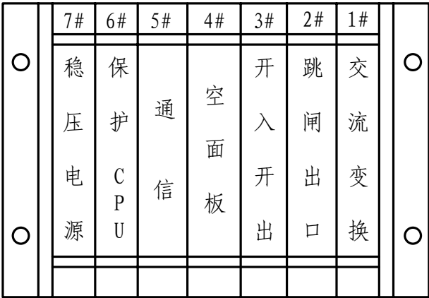
图 4-2-2 不带测控功能的 WBH-813 装置背视示意图
