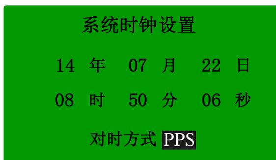
当光标位于对时方式选择框时，可以对装置的对时方式进行修改。按“+”、“-”键可以在“PPS”、“PPM”、“B 码”之间进行对时方式的选择。
