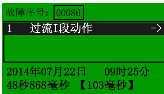
光标位于故障序号框中，故障序号为最新的故障序号，按“+”和“-”键可以依次查看故障报告。
