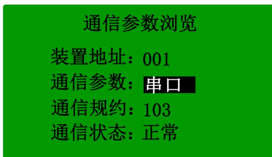
按“+、-”键可以选择通信参数，当通信参数显示为“串口”时按“确定”键显示串口通信参数，如下图：
