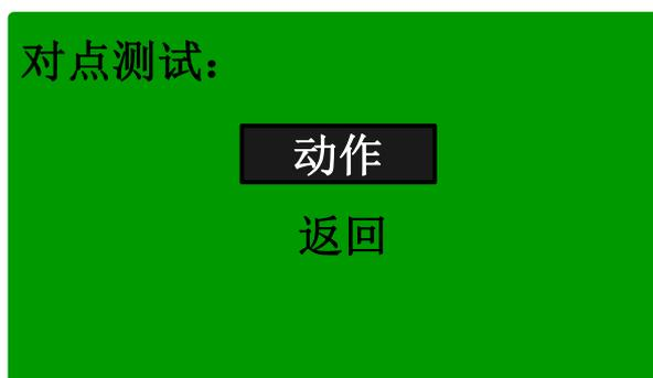
在对话框中，按“↑”和“↓”分别向上和向下移动光标选择动作和返回，选中后按“确定”键即可完成一次对点测试。
