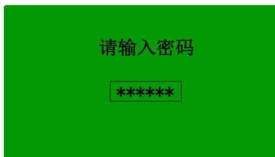
密码最大位数为 6 位，有四个方向键组成。输入完成后按“确定”键，如果密码错误，弹出对话框，提示用户密码不正确并返回到定值修改界面。如果密码正确，弹出对话框，提示用户定值存储成功。
